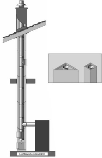
Furado - система легковозводимых шахт из силиката кальция прямоугольного, квадратного и треугольного сечения.
