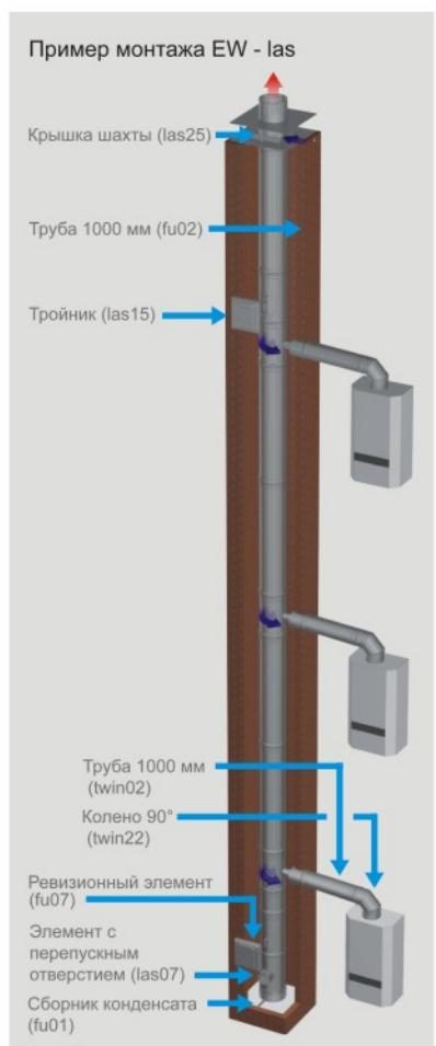
Система EW-LAS предназначена для подключения нескольких котлов к общему вертикальному каналу отвода продуктов сгорания. Вертикальный канал отвода продуктов сгорания размещается в шахте в строительном исполнении, расположенной внутри здания. Приток воздуха для горения к каждому котлу осуществляется от устья общего вертикального канала по пространству, заключенному между внутренними стенками шахты и наружной стенкой трубы, отводящей продукты сгорания от присоединенных котлов.
